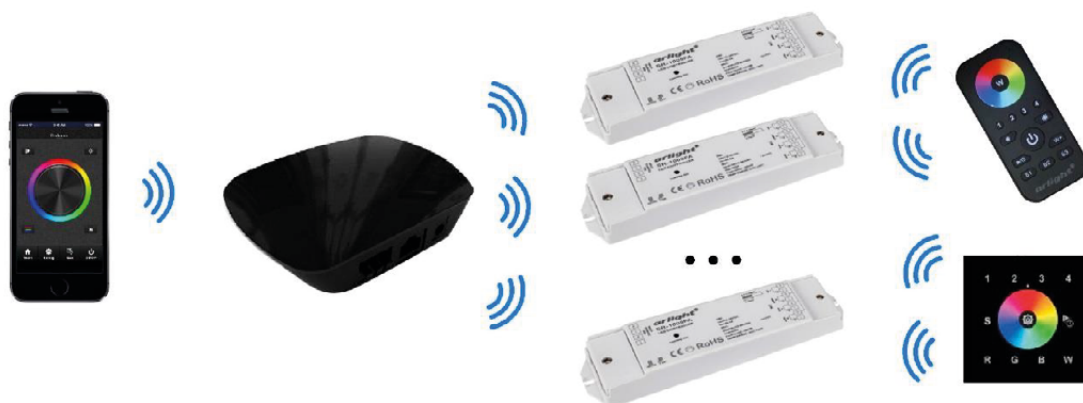
Рис.1. Прямое подключение смартфона к конвертеру (без использования домашней сети).
