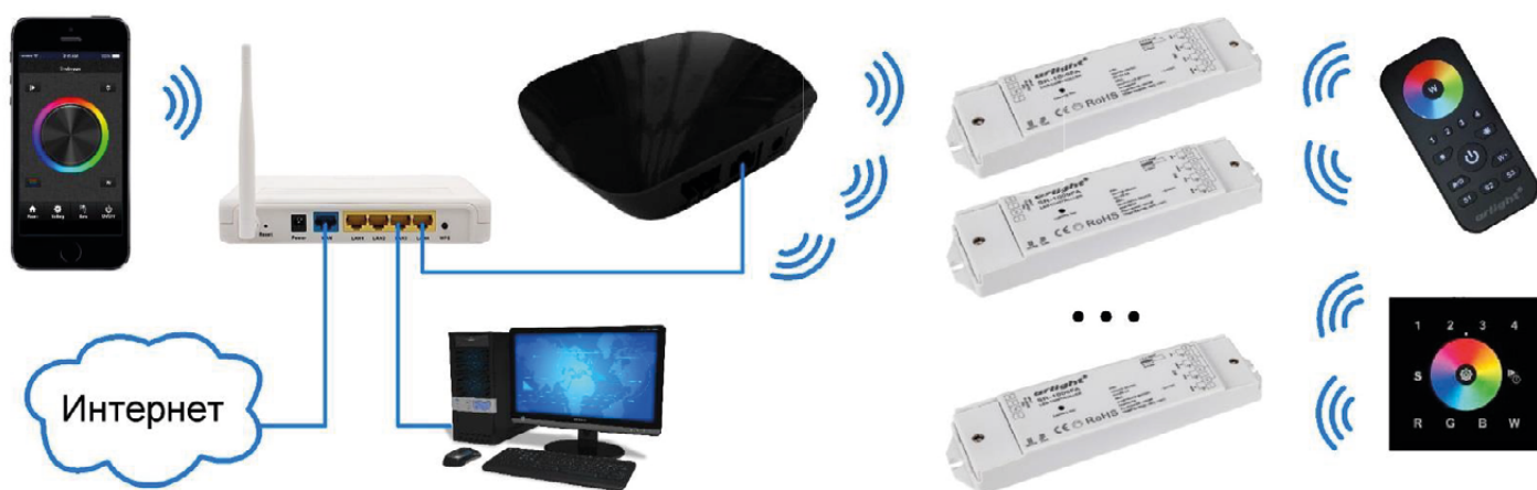
Рис.3. Подключение через роутер с использованием проводного соединения.
