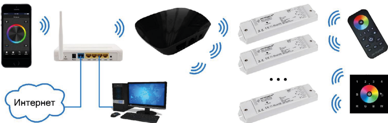
Рис.2. Подключение через роутер с использованием домашней WiFi сети.
